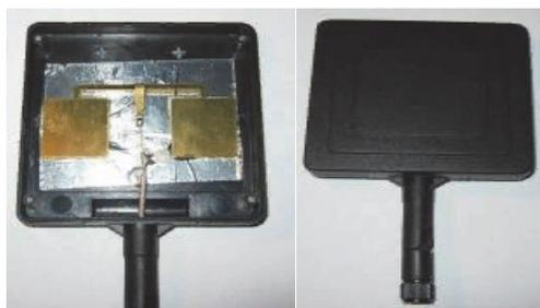
Рисунок 3 - Направленная принимающая антенна для видеосигнала
