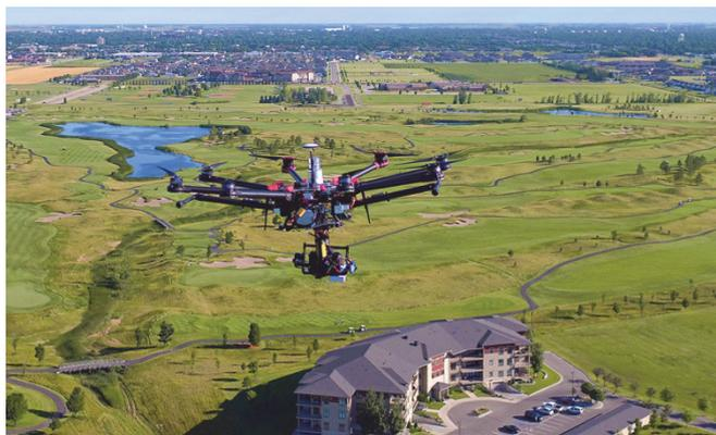
Рисунок 2 - Дистанционное зондирование местности с БПЛА мультироторного типа
