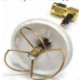
Рисунок 4 - Всенаправленная передающая антенна типа “клевер” для БПЛА
