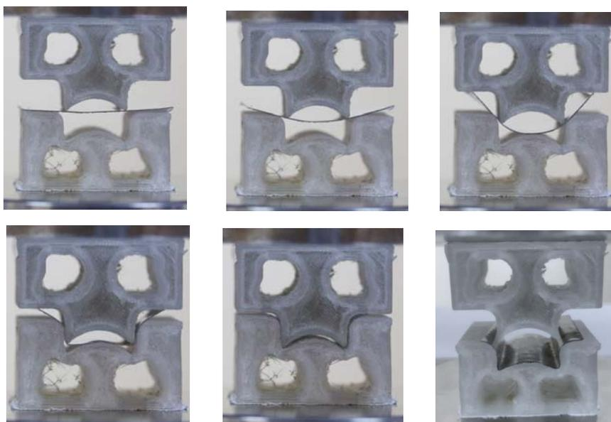
Рисунок 3– Поэтапный процесс формоизменения листовой заготовки с помощью оптимизированных штамповочных инструментов из пластика РС
